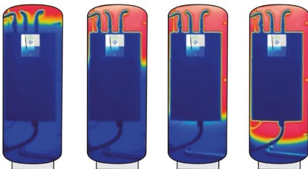
Entladung durch Frischwasserewärmer
