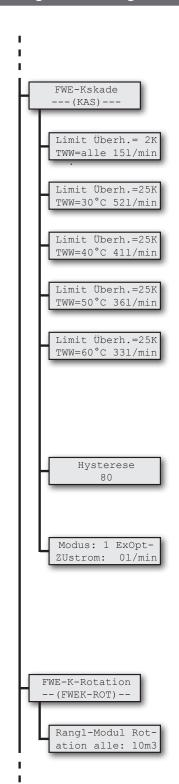
Die **Limit**-Werte bestimmen, ab welchem Gerätedurchfluss das TWK-Ventil des Folgemoduls geöffnet wird und damit ein weiteres Gerät im Kaskadenverbund in Bertrieb geht. Dabei wird die Temperaturdifferenz (Überhöhung) zwischen Speichertemperatur und TWW-Solltemperatur berücksichtigt.
