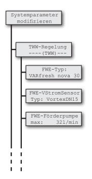
In diesem Menüpunkt können Systemparameter eingesehen und geändert werden. Diese Parameter werden bei Inbetriebnahme automatisch auf Werkswerte gesetzt und können für Optimierungszwecke angepasst werden.
