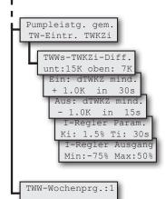
Dieser Menüpunkt dient der Optimierung der Trinkwassererwärmung bei Zirkulationsbetrieb und damit hoher Tauschereintrittstemperatur. Anpassungen sind nur in Abstimmung mit unserem Servicepersonal ratsam.
