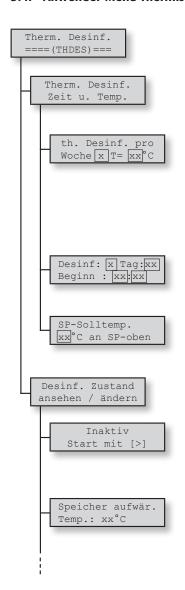
Hauptmenü für die Durchführung einer thermischen Desinfektion. Betätigen Sie die "OK-Taste", um in das nächste Untermenü zu wechseln.
